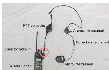
Imagen 9. Partes del intercraneal
