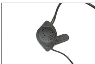
Imagen 10. Micrófono y auricular del Intercraneal
